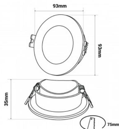
**Aro downlight estanque circular para lâmpada GU10 / MR16 - Difusor opalino- Corte Ø 75-80 mm - IP54**
