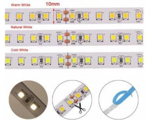
**LED-Streifen 24V DC - 15W/m - einfarbig - 10 mm - IP20 - 30 m lang - 120 LED s/m - Schnitt alle 10 cm**
