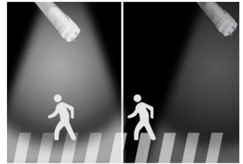
Se conecta al 100% de su potencia una vez se detecta presencia dentro del área del sensor (6-10m)
