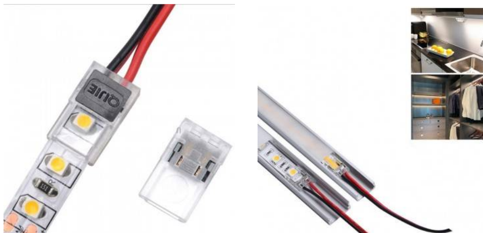
Schnellverbinder CLIP 2-polig - Abisolierung auf Kabelplatine 10mm IP20 max. 24V
